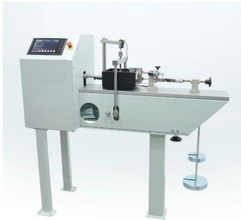
Visualización de la velocidad en pantalla, sistema de desplazamiento impulsado por un motor paso a paso de alta resolución y una unidad de reducción de tornillo sinfín, puede utilizarse con todo tipo de muestras de tamaño estándar de hasta 10 cm cuadrados y 10 cm de diámetro.
